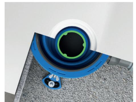
Das Flex-Element kompensiert seitliche Abweichungen zwischen Ablaufgehäuse und Duschwanne um bis zu 2 cm von der Mitte aus in jede horizontale Richtung.
